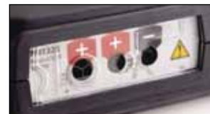
Pokrovček na merilnih pušah preprečuje nevarno kombinacijo priključitve merilnih vrvic.
