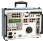
Sverker je najbolj popularen instrument za testiranje enofaznih zaščitnih relejev
